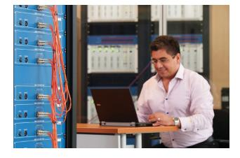
FIBRE CABLES CONNECT SIMULATED VALVES TO SIMULATED CONTROLLERS ON VARIOUS GTFPGA UNITS
