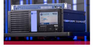
THE RTDS SIMULATOR IS USED TO TEST A REAL-TIME AUTOMATION CONTROLLER FOR MICROGRID FREQUENCY CONTROL VIA DNP3 AND GOOSE MESSAGING
